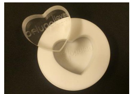
Fig. 5 : Het moedermodel boven op de moedermal van siliconen.
