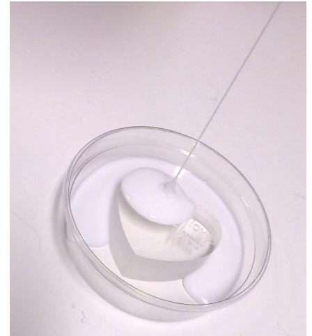
Fig. 4 : Met een dunne straal wordt het model tot het gewenste niveau en luchtbelvrij afgegoten.
