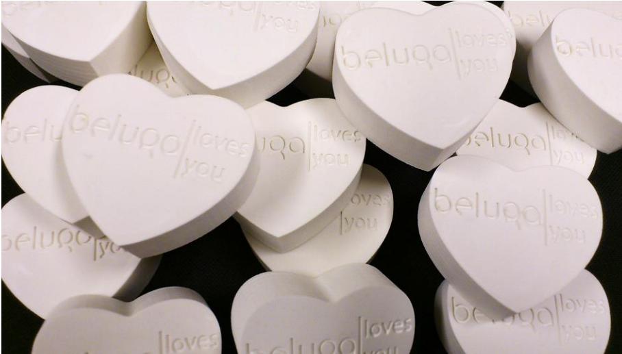
Fig. 7 : 20 modellen uit Porseleingips in de juiste positie op een plank geplaatst.
