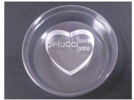
Fig. 3 : Moedermal, vastgezet met lijm in een plastic bakje.
