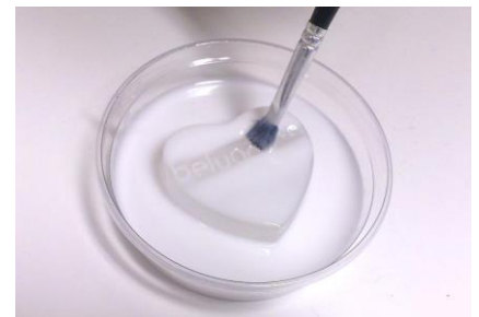
Fig. 4.b. : Met een dunne straal wordt het model tot het gewenste niveau en luchtbelvrij afgegoten.
